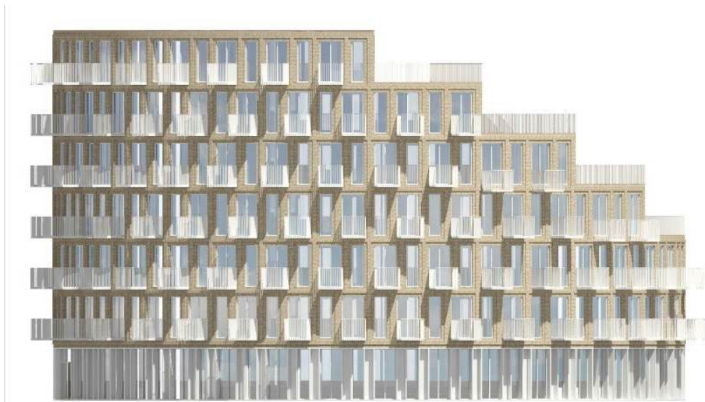
Figur 3 - Illustration af facaden i gule tegl og med en stueetage, der i visuelt adskiller sig fra de øvrige etager.
